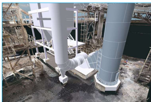
新規設備の3DCADデータを落とし込むことで事前に干渉物がないか確認が可能となります
