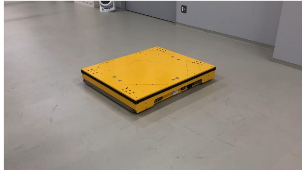
▶ 製作（株）ケンコントロールズ 低床全方向移動搬送台車（1ton）
