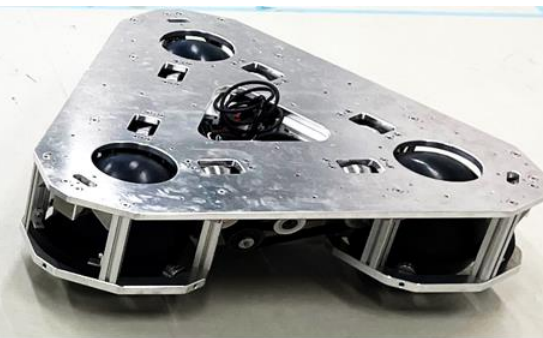
寸法：W733 x D683 x H200mm 重量：49.5kg（球：Φ200mm）
